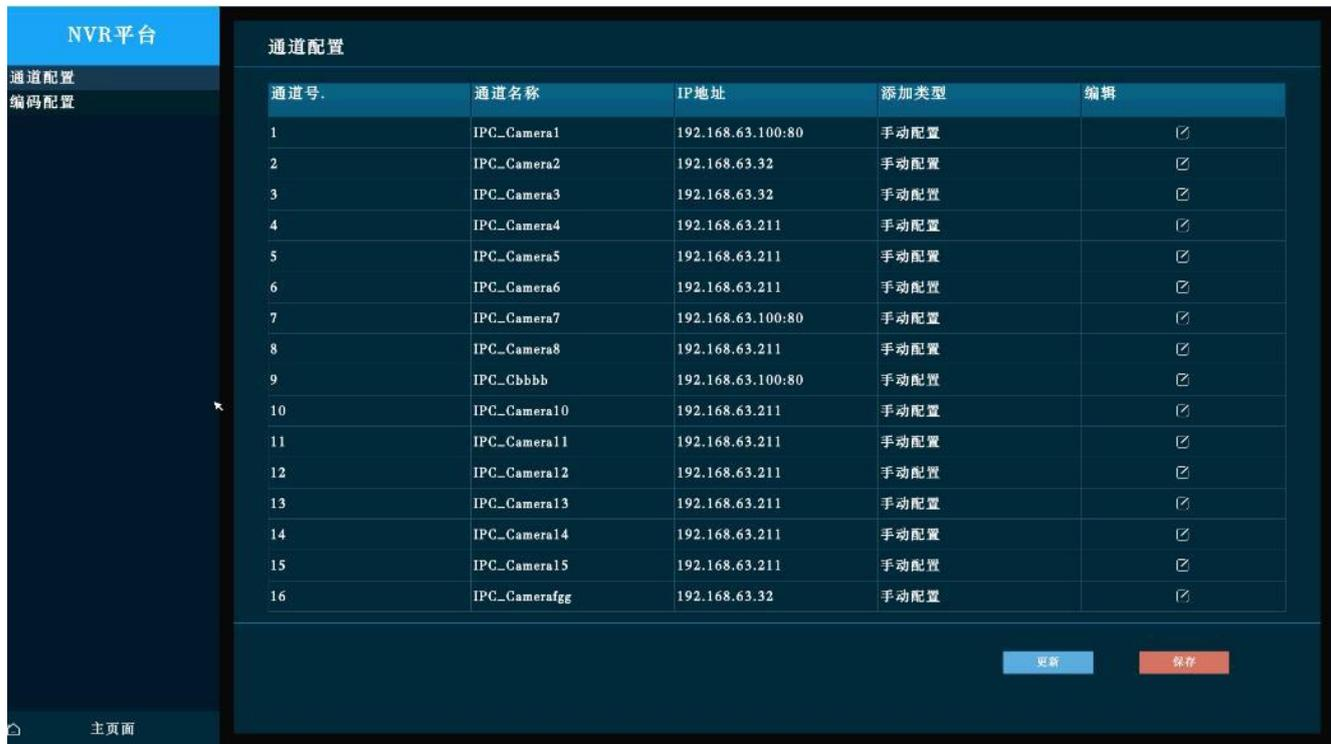
通道配置页面的内容可以预览不能编辑，编辑需点击对应通道的  图标，弹出通道编辑界面
