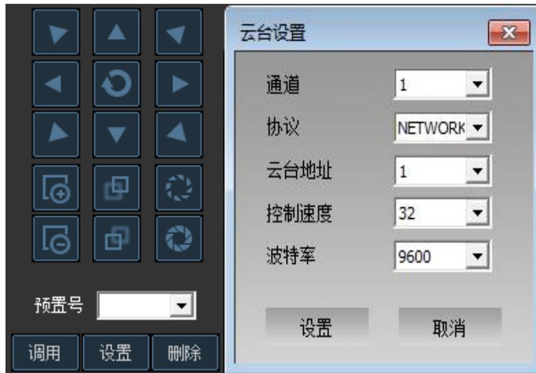
点击“云台设置”，进行要操作的云台通道、云台协议、云台地址、云台速度、波特率设置，设置完成后在控件主界面上的“上”、“下”、“左”、“右”等按钮可进行云台设备操作。
